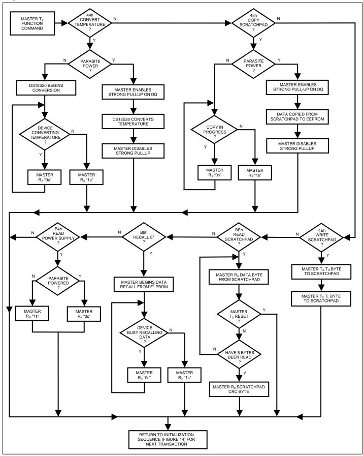
Figure 15. DS18S20 Function Commands Flowchart
